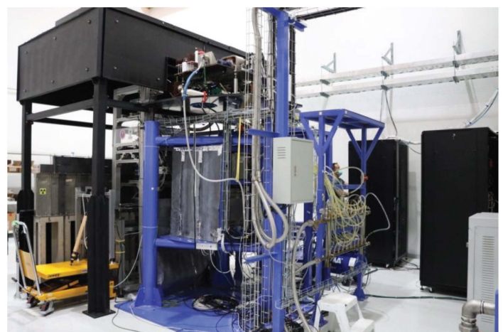
เครื่อง Proton computed tomography เพื่อใช้เป็นต้นแบบของเครื่องมือรักษาโรคมะเร็งแบบแม่นยำสูง ที่จะนำมาประยุกต์ใช้งานทางด้านการแพทย์
