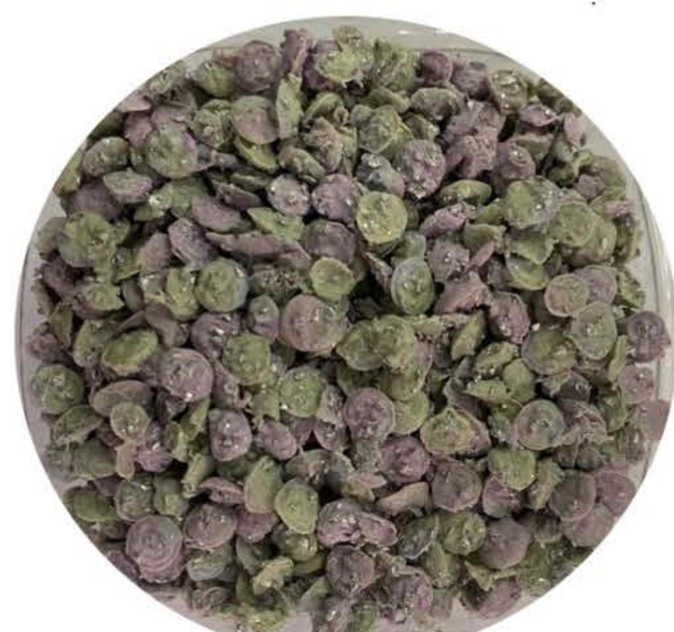
รูปที่ 3 ผลการทดลองขึ้นรูปเม็ดคอมพาวด์จากขยะอุตสาหกรรมจากการผลิตหลอดยาสีฟัน
