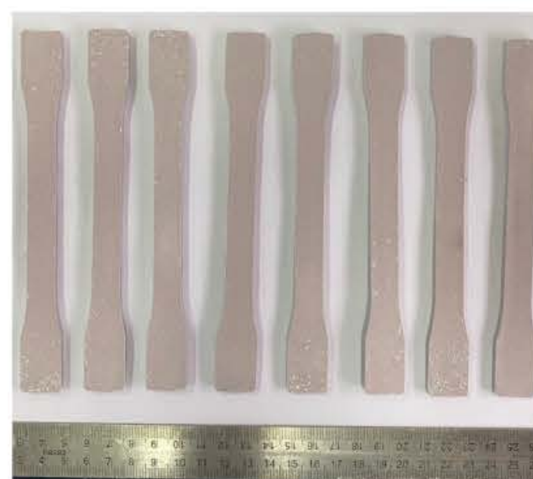
b) ชิ้นทดสอบแรงดึงจากการขึ้นรูป
