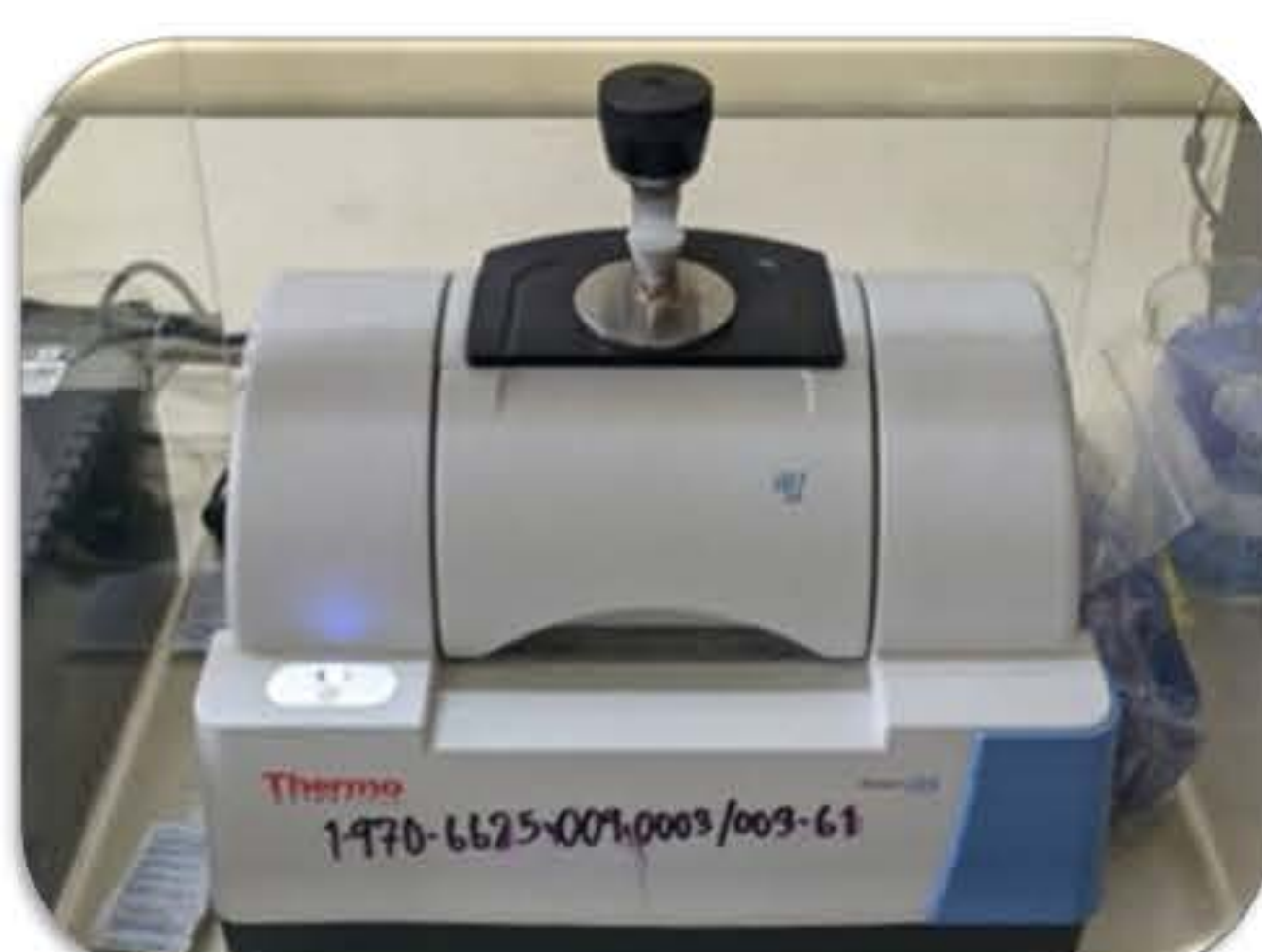
เครื่องฟูเรียร์ทรานส์ฟอร์มอินฟราเรดสเปกโตรมิเตอร์ (Fourier transmission infrared (FTIR) ; ATR Model : Nicolet iS5-ID7 Thermo Scientific)
