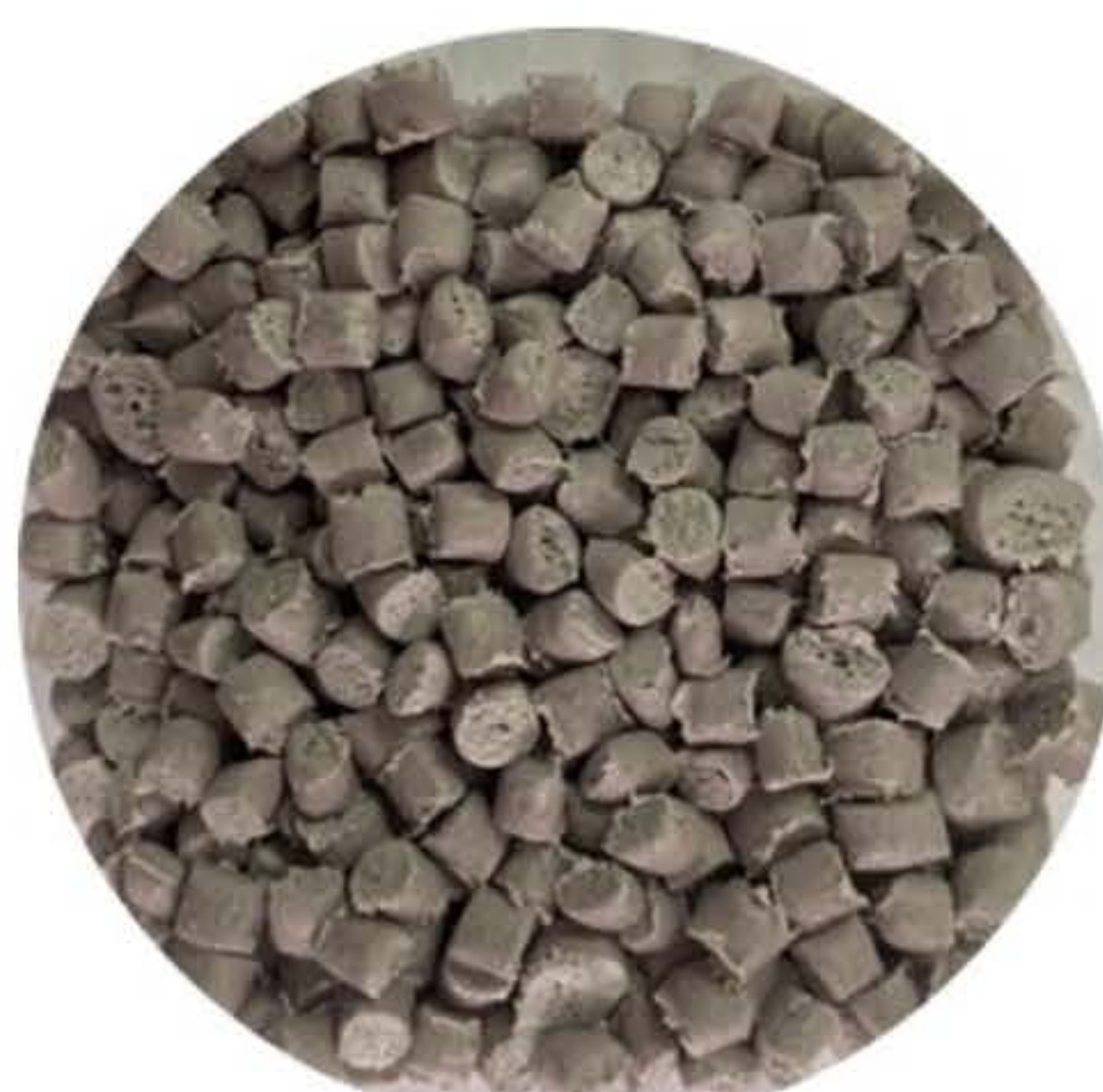
รูปที่ 3 ผลการทดลองขึ้นรูปเม็ดคอมพาวด์จากขยะอุตสาหกรรมจากการผลิตหลอดยาสีฟัน
