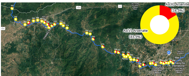
ผลการวิเคราะห์สปีชีส์เคมีและสถานะออกซิเดชันของสารหนู (As) ในตัวอย่างตะกอนจากแม่น้ำกก โดยใช้เทคนิค synchrotron X-ray absorption spectroscopy
